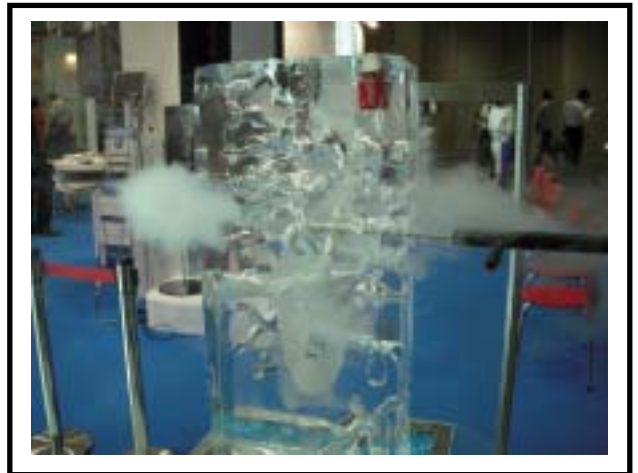
ナノ蒸気で氷柱を瞬時に貫通 (東京ビックサイトにて)
